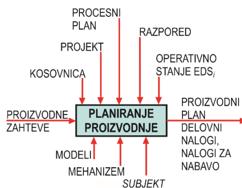
Slika 4.14. Digitalizirana funkcija planiranja proizvodnje (Hozdić 2020b)
